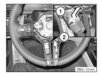
車線逸脱警告システム モーター エレクトロニクス(1)を矢印方向にステアリング ホィール(2) から取り出す。
