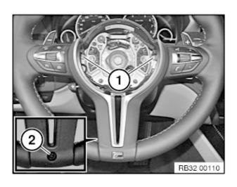
ステアリング ホィールのボルト(1)を外す。 ステアリング ホィール裏側のボルト(2)を外 す。
